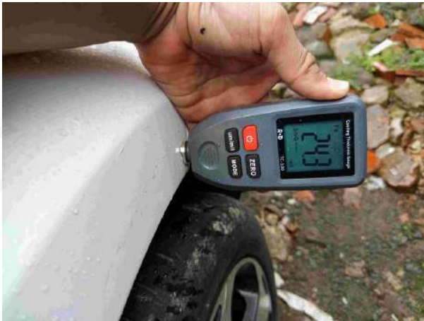
ADA BEKAS DEMPUL DAN REPAINT
