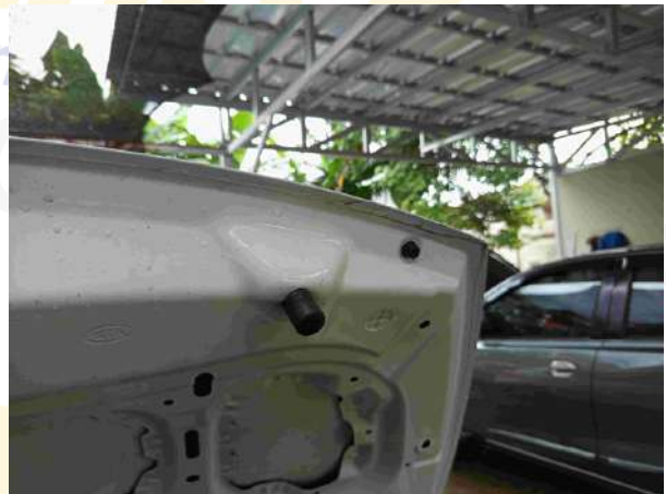
SEALER KAP MESIN TIDAK ADA
